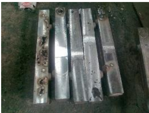
Gambar 0.1 Cacat cor pada benda Replacable Lip
