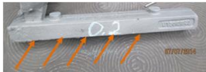
Gambar 0.11 Bagian benda yang dilakukan pemesinan dengan komposisi deoksidasi 0.2
