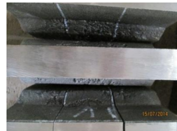
Gambar 0.9 Visual penampang melintang pada Y - Block
